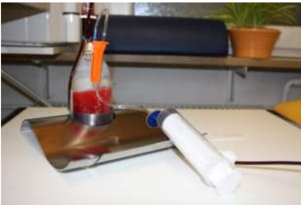
Zugabe des Ozons über das Mikroperlsystem
